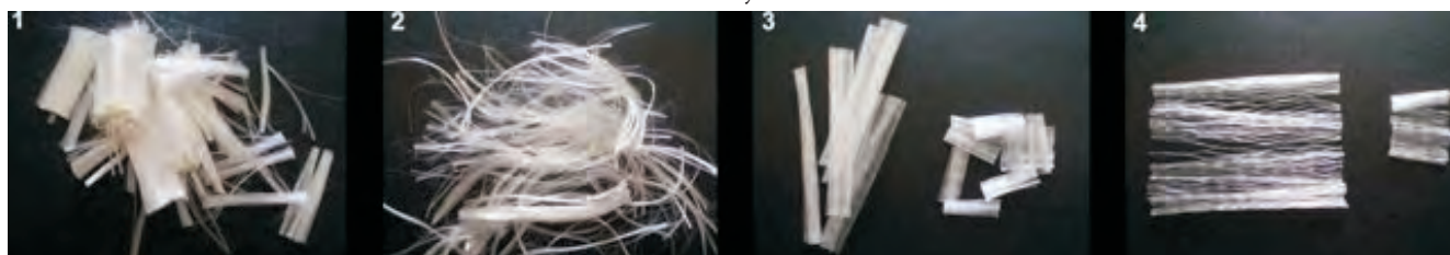
Obr. 8 Druhy vláken: 1 – polyesterová staplová (jednoduchá), 24 mm; 2 – polyesterová staplová (jednoduchá), 70 mm; 3 – polypropylenová fibrilovaná, 24 mm; 4 – polypropylenová fibrilovaná 70 mm
